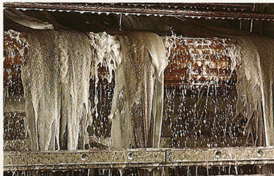
Fase di lavaggio/risciacquo in corda, a bassa velocità Scouring/rinsing process in rope form, at low speed Lavage/rinçage sans couture à sac, à baisse vitesse Waschen/Spülen im Strang, bei niedriger Geschwindigkeit Operacion de lavado/aclarado en cuerda, a baja velocidad
