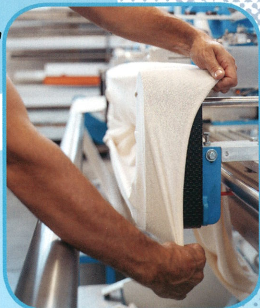
Portatessuto in cucitura a mezzo 2 nastri motorizzati a posizione variabile in funzio- ne del diametro del tubolare
